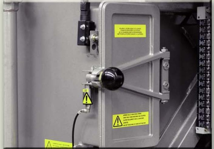
Eine neu entwickelte Trocknungssystem mit einem extrem großen Lüfter reduziert Trocknungszeiten der Modellen XL-XP 8000 im Vergleich zu früheren Maschinen. Für einen optimalen Schutz der Trockentunnel Wärmetauscher werden alle Modelle mit zwei Luftfiltern ausgestattet. Diese sind durch eine große Inspektion Tür leicht gewartet. Die tägliche Wartung wurde durch die Einbeziehung dieser einfachen Zugang für den Doppelluftfilter zusammen mit dem Nadelfänger vereinfacht.
