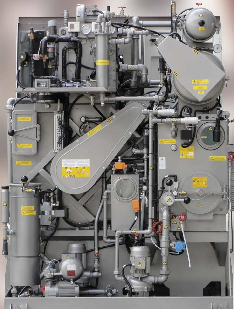
Logische und ergonomische Auslegung für die Bedienungsfreundlichkeit und einfacher Zugriff auf alle zu wartenden Teile. Die Maschinen verfügen über Schleuderfilter, mit ökologischen Filterscheiben, die mit Aktivkohle-Kartuschenfiltern zum Entfärben kombinierbar sind. Die übersichtliche Struktur ermöglicht einen problemlosen Zugriff auf die großflächigen Luftfilter und den Nadelfänger.
