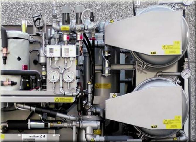
Alle HXL-HXP 8000 Maschinen von Union verfügen über mehrfache, voneinander unabhängige, selbstreinigende Hochmikron-Schleuderfilter des Typs Eco und Aktivkohlekartuschenfilter mit großer Kapazität. Dadurch wird eine optimale Filtration von großen und kleinen Partikeln erzielt, mit der größtmöglichen Reinheit des Lösemittels. Der Computer **DIALOG** steuert automatisch den Betrieb der Filterpaare für weiße, dunkle oder farbige Ware, gemäß der spezifischen Programme.
