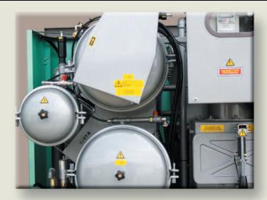
Alle HP-HL 800 Maschinen von Union verfügen über mehrfache, voneinander unabhängige, selbstreinigende Hochmikron-Schleuderfilter des Typs Eco® und Aktivkohlekartuschenfilter mit großer Kapazität. Dadurch wird eine optimale Filterung von großen und kleinen Partikeln erzielt, mit der größtmöglichen Reinheit des Lösemittels. Der Computer steuert automatisch den Betrieb der Filterpaare für weiße, dunkle oder farbige Ware, gemäß der spezifischen Programme.
