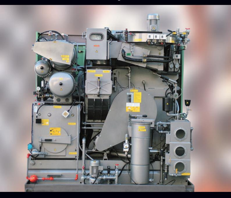
Logische und ergonomische Auslegung für die Bedienungsfreundlichkeit und einfacher Zugriff auf alle zu wartenden Teile. Ein neues, computergezeichnetes Kälteregister gewährleistet die höchstmögliche Trocknungsleistung.
