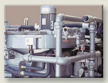
Optimale, computergesteuerte Abstimmung der Kaltlufttemperatur und des Luftstroms zur Reduzierung der Lösemitteldämpfe auf den niedrigsten Grenzwert, d.h. Verminderung der Lösemittelemissionen und perfekte Trocknung der Ware. Alle Betriebszustände sind sichtbar. Einfach ablesbare Manometer und digitale Anzeigefelder zeigen die Kaltlufttemperatur an. Ein neues, computergezeichnetes Kälteregister gewährleistet die höchstmögliche Trocknungsleistung.
